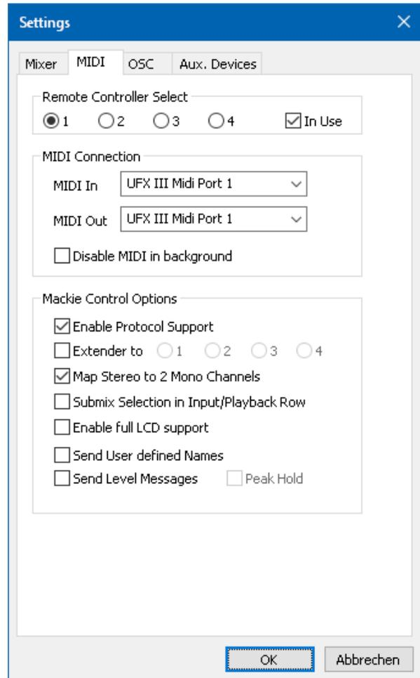
**Hinweis:** Wird als MIDI Out NONE gewählt, kann TotalMix FX auch per Mackie Control MIDI Befehlen ferngesteuert werden, es erscheint aber keine Kennzeichnung eines 8-kanaligen Kanalblocks.
