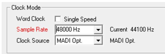
Unter ASIO setzt die Audiosoftware die Sample Rate selbst, so dass dieser Fehl-Zustand normalerweise nicht auftreten kann – in der Praxis aber doch. Denn im Slave-Mode hat die externe Samplefrequenz Priorität. Ein Eingangssignal mit 44.1 kHz verhindert die Umschaltung der ASIO Software zu 48 kHz – offensichtlich, denn der einzige Weg dies zu tun wäre ein anderer Clock Mode (Master/Internal).
