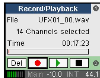
**Transport Bar.** Durch Drehen des Encoders 2 bewegt sich der Cursor über *Del* (Delete), *Stop*, *Play/Pause* und *Record*. Die selektierte Funktion wird durch einen Druck auf Encoder 2 aktiviert. Bei Wiedergabe ändern sich *Del* / *Record* zu *Previous File* / *Next File*.
