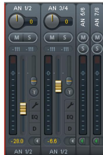
Mit dem **Pfeilsymbol** lässt sich ein Kanal horizontal verkleinern, so dass nur noch die Level Meter zu sehen sind. Ein Mausklick bei gedrückter Strg-Taste führt zum Ein- und Ausklappen aller weiter rechts befindlichen Kanäle.
