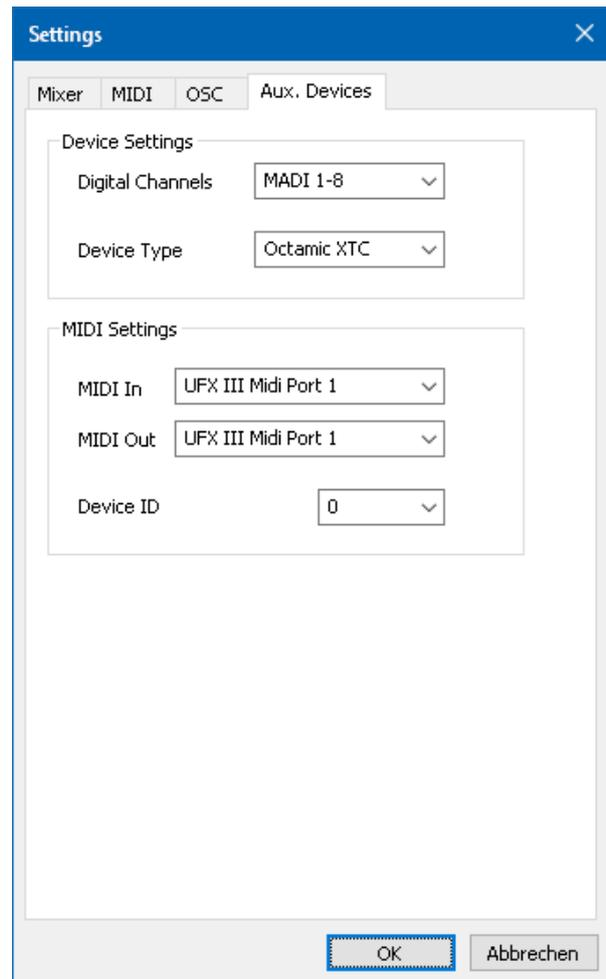
Bei der Nutzung mehrerer OctaMic XTC müssen diese unterschiedliche Device IDs besitzen (Konfiguration erfolgt im OctaMic XTC). Auch in *Aux Devices* lassen sich den 8-Kanal Blöcken verschiedene Device IDs zuweisen. Die Speicherung erfolgt sofort bei Auswahl einer Device ID. Die Prüfung der Zuweisungen erfolgt durch abwechselnde Anwahl der beiden 8-Kanal Blöcke.
