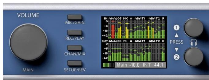
Während der Anzeige des Global Level Meter Bildschirms dient der Drehgeber (Encoder) **VOLUME** zur schnellen Einstellung der Monitorlautstärke des Main Out. Encoder 1 und 2 steuern die Lautstärke der Kopfhörerausgänge 9/10 und 11/12.
