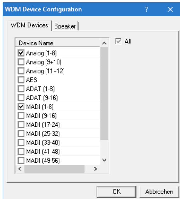
Der Screenshot links zeigt die Multichannel WDM Devices des UFX III nach Auswahl der Option 'Multi-Channel' im Feld WDM Devices und Klick auf den Knopf *WDM Configure*. In diesem Beispiel sind die Devices *Analog 1 bis 8* und *MADI 1 bis 8* aktiviert.
