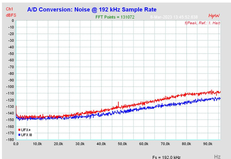
Wie im Bild zu sehen bleibt der Rauschteppich selbst außerhalb des Hörbereichs auf sehr niedrigem Niveau. Bei Samplefrequenzen von 96 kHz oder höher erfolgt das Noise-Shaping komplett außerhalb des Hörbereichs. Die verbesserten Noise-Shaping Filter des im UFX III eingesetzten AD-Wandlers zeigen zudem weniger Rauschanstieg über die Frequenz als frühere Wandler, wo beispielsweise eine Weitbereichsmessung über 96 kHz nicht -88 dBFS, sondern nur -79 dBFS erreichte.
